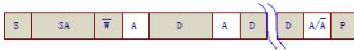
图 1.4 主机向从机发送数据的基本格式
